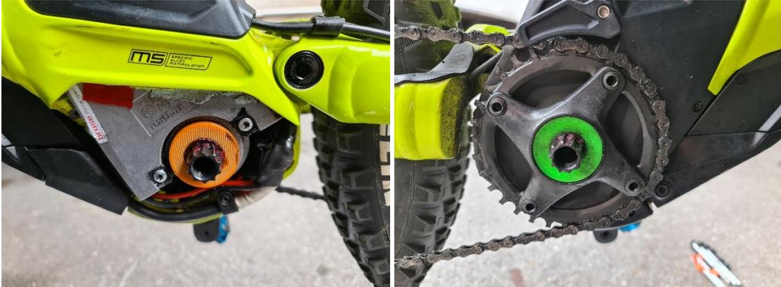
Se trata de material plástico PETG impreso en 3D, las dos van ajustadas al eje y con grasa en la parte interna, la del lado derecho (plato) lleva una tórica para ajustar perfectamente al interior de la araña, la tórica puede ser cualquiera entre 22 y 40mm x2mm no es crítico el diámetro, si hay que respetar los 2mm de grosor.
